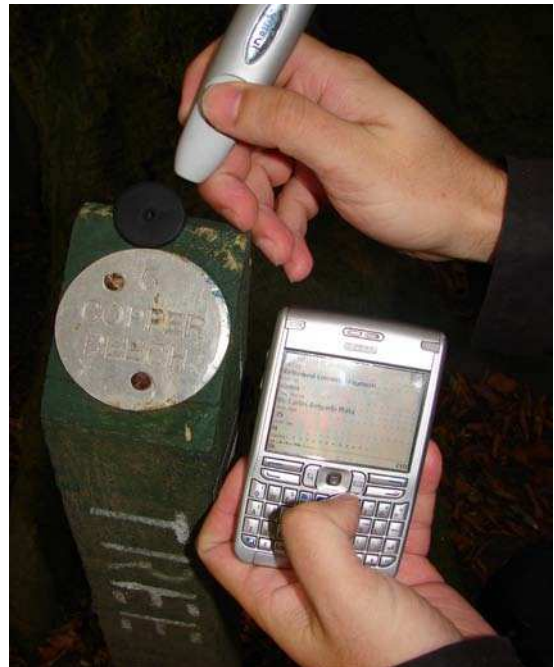
Fig. 5. Lectura de tag RFID
